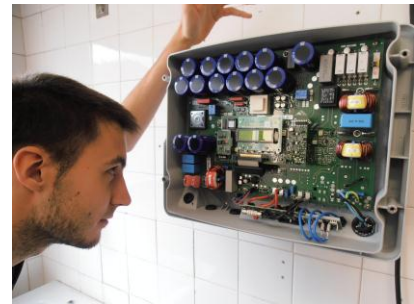
Análisis del conexionado de CC, CA y comunicac. del inversor.
