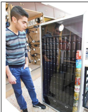
Panel solar para calentamiento de aire a base de latas.
