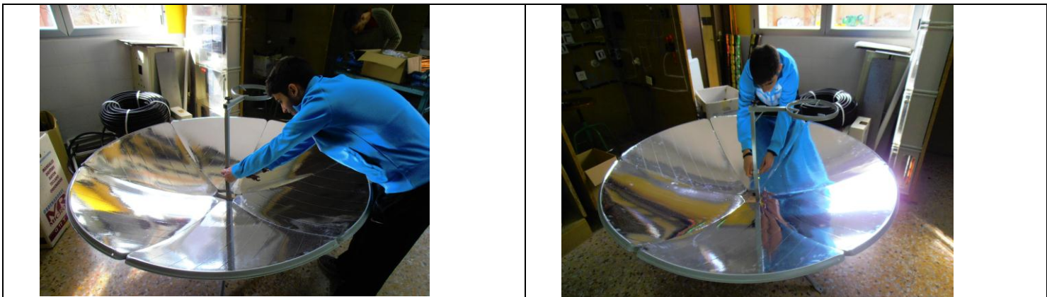
Ajuste del concentrador solar parabólico o cocina solar.
